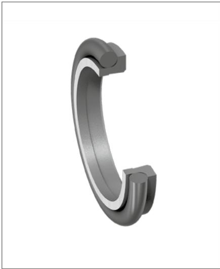
La funzione degli anelli raschiatori è impedire la penetrazione di polvere, sporcizia, sabbia e sfridi metallici negli steli e negli stantuffi con movimento assiale. In tal modo si evita ampiamente lo sviluppo di graffi, gli elementi guida e le guarnizioni sono protetti e la durata del sistema di tenuta è maggiore.
