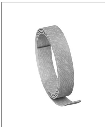
I nastri guida FC sono estremamente resistenti all'usura e adatti per guide di pistoni e steli. Possono essere tagliati a qualsiasi lunghezza (max. 5,5 m). I nastri sono avvolti su bobine con un diametro di nucleo di circa 120 mm. Il nastro guida FC viene venduto in rotoli da 5,5 m (la lunghezza desiderata deve essere tagliata dal cliente).
