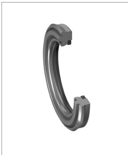
La guarnizione per stelo profilo BU in Ultrathan® è una guarnizione compatta con un anello antiestrusione integrato. Un'applicazione tipica di questo profilo di guarnizione è l'uso come guarnizione reggispinta in sistemi di tenuta spesso presenti su cilindri di macchine per l'edilizia. Tali cilindri funzionano in condizioni estreme, in cui non sono insolite pressioni fino a 1000 bar.
