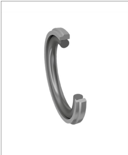
Il set di guarnizioni per pistone a effetto singolo profilo OG è costituito da un anello di tenuta per pistone in PTFE e da un O-ring in elastomero come elemento di precarico.
