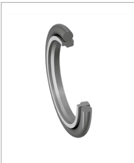
Il set di tenuta per stelo a singolo effetto profilo OD è costituito da un anello di tenuta per stelo in PTFE e da un O-ring in elastomero come elemento di precarico. La sezione asimmetrica dell'anello di tenuta è progettata per le migliori prestazioni di trascinamento dell'olio durante la corsa in entrambe le direzioni. Si ottengono prestazioni di tenuta ottimali se il set di guarnizioni per stelo viene utilizzato in tandem con un raschiatore a doppio effetto.
