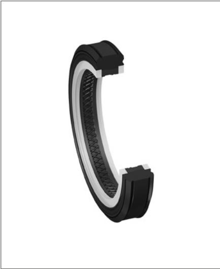
Il sistema di tenuta per distributore rotante profilo KA è costituito da una parte di tenuta in gomma rinforzata con tessuto e due anelli antiestrusione per aumentare la stabilità e impedire l'estrusione nel gioco, in particolare per tutte le applicazioni in cui si verifica eccentricità.
