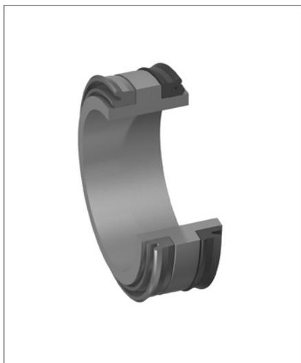
Il set di tenuta in Ultrathan® profilo KS è stato sviluppato in particolare per la tenuta di pistoncini in accumulatori idraulici a doppio fluido. È costituito da due U-ring con design e materiali diversi. La forma delle guarnizioni le rende ideali per la separazione permanente dei fluidi pressurizzati, p. es. olio e gas con basse forze di attrito.
