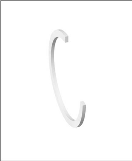
Gli anelli antiestrusione si utilizzano per applicazioni statiche e dinamiche insieme a O-ring, per evitare l'estrusione dell'O-ring nel gioco diametrico.
